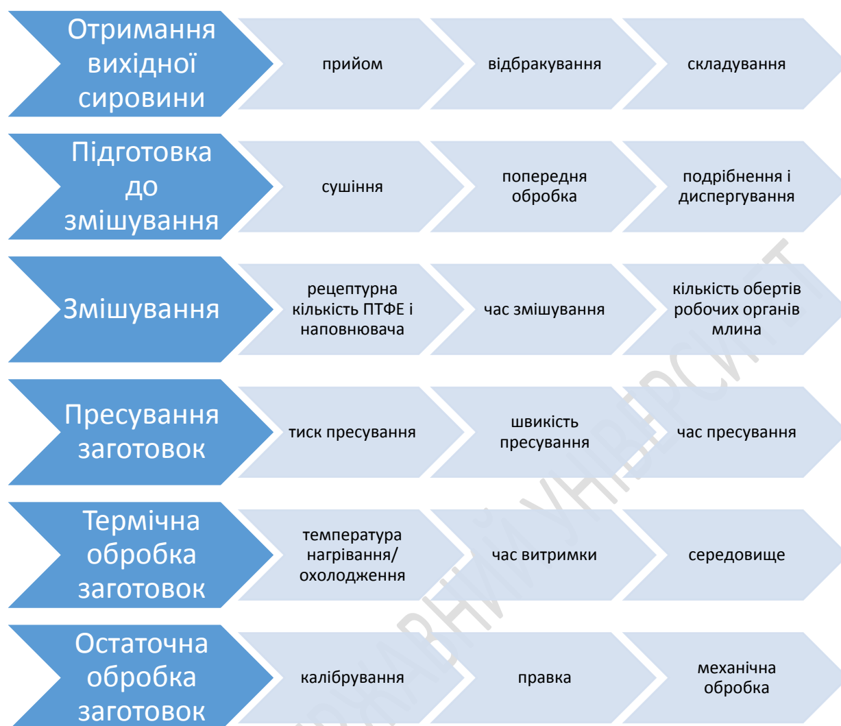
Рисунок 3. Схема технології отримання ПТФЕ-композитів.
