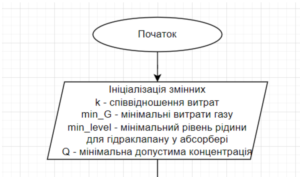
Рисунок 4.4 - Початок на операторна підготовка системи до роботи
