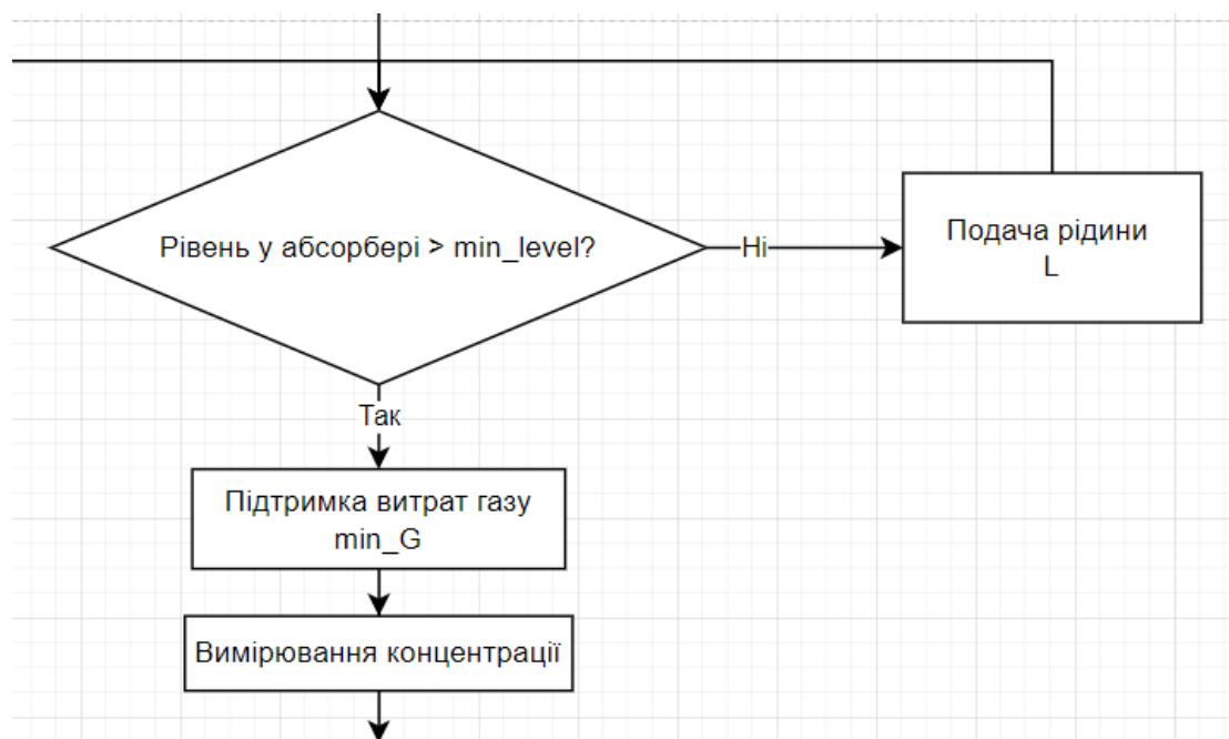
Рисунок 4.5 - Алгоритм підготовчого заповнення рівню у абсорбері для гідра-клапану.
