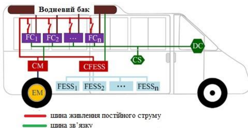
Рисунок 3.8 – Схема системи автомобіля: FC – паливний елемент; FESS – система накопичення енергії маховика; EM – електричний двигун; CS – система контролю; CM – тяговий мотор-конвектор; CFESS – маховий конвектор; DC – управління водінням
