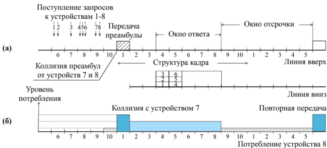
Рисунок 2.4 – Приклад роботи процедури випадкового доступу в часі (а) і приклад енергоспоживання для терміналу номер 8 (б)
