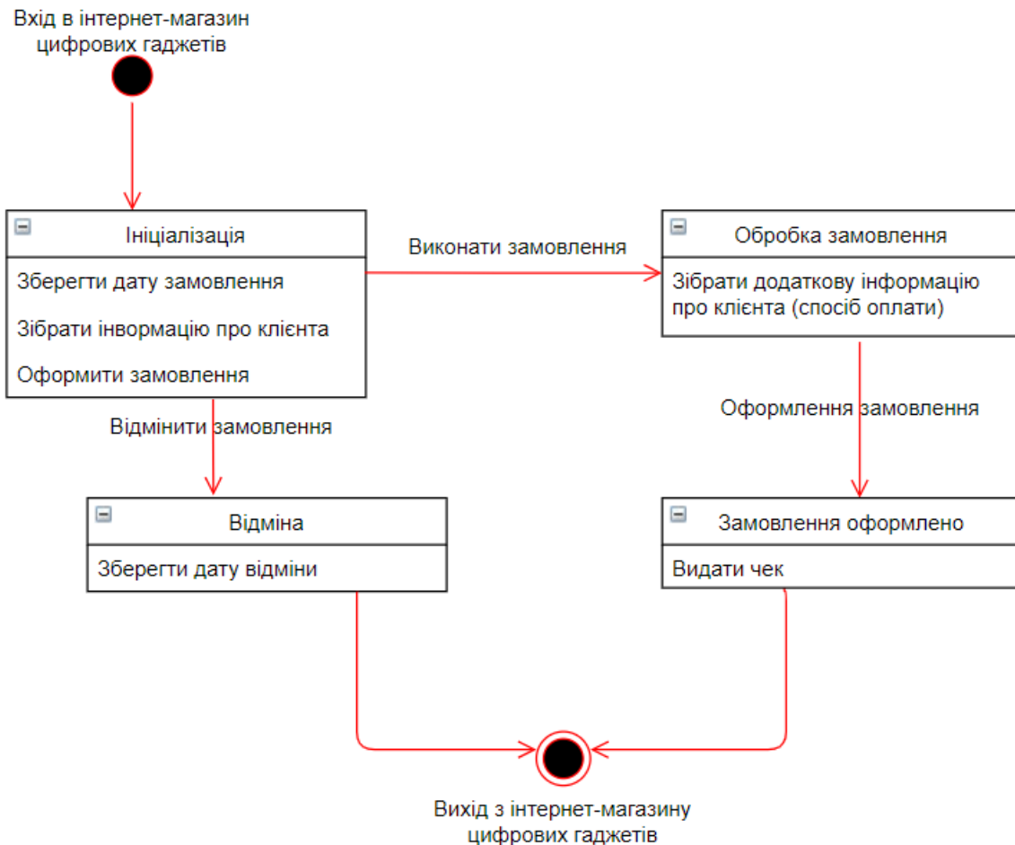
Рисунок 2.7 – Схема взаємодії клієнта з веб-додатком
