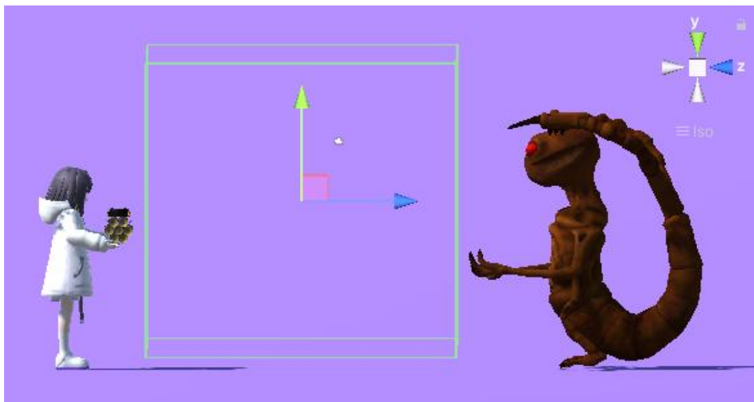
Рисунок 3.18 – Демонстрація виду границь колайдера ігрового об'єкта з класом «FlyingArea» у редакторі «Unity»
