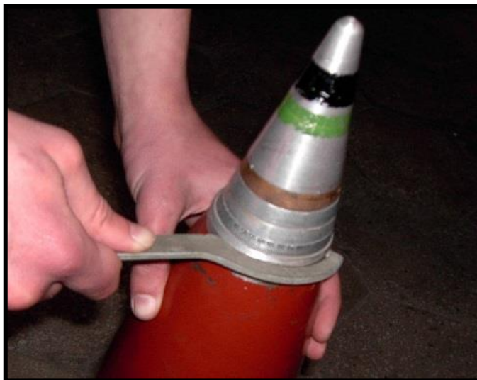
Рисунок 6.30 – Догвинчування підривника Т-7
