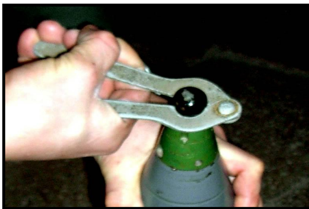
Рисунок 6.3 – Згвинчування ковпачка за допомогою лещат
