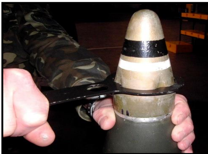
Рисунок 6.21 – Згвинчування запобіжного ковпака ключем 42-78
