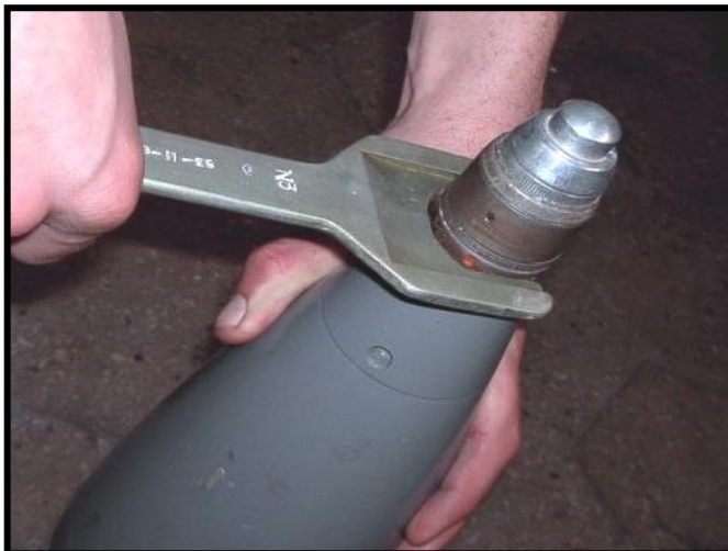
Рисунок 6.28 – Догвинчування підривника В-90
