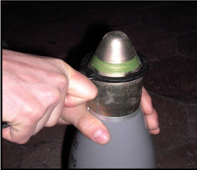
Рисунок 6.13 – Згвинчування гермоковпака ключем ЗИ38
