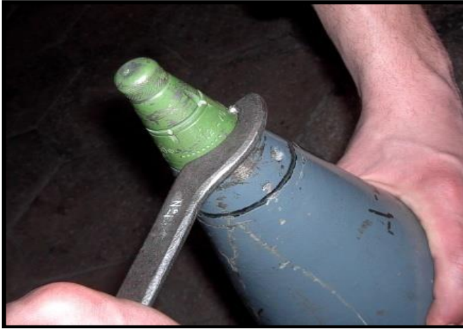
Рисунок 6.26 – Догвинчування підривника РГМ-2
