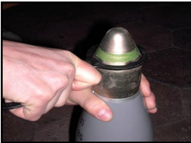
Рисунок 6.16 – Згвинчування гермоковпака ключем 9Ф371
