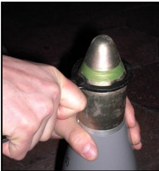
Рисунок 6.5 – Згвинчування гермоковпака ключем 42-78
