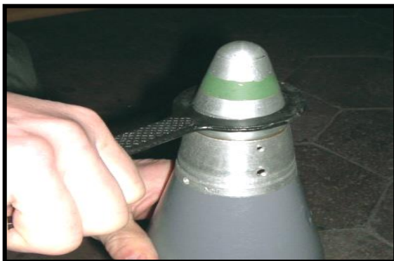
Рисунок 6.17 – Установка ключа 9Ф371 на підривник
