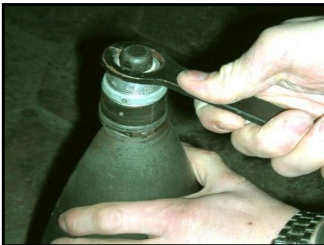
Рисунок 6.9 – Установка ключа ЗИ37 у паз головної втулки
