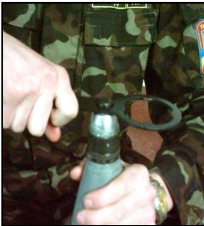
Рисунок 6.11 – Згвинчування установлювального ковпачка
