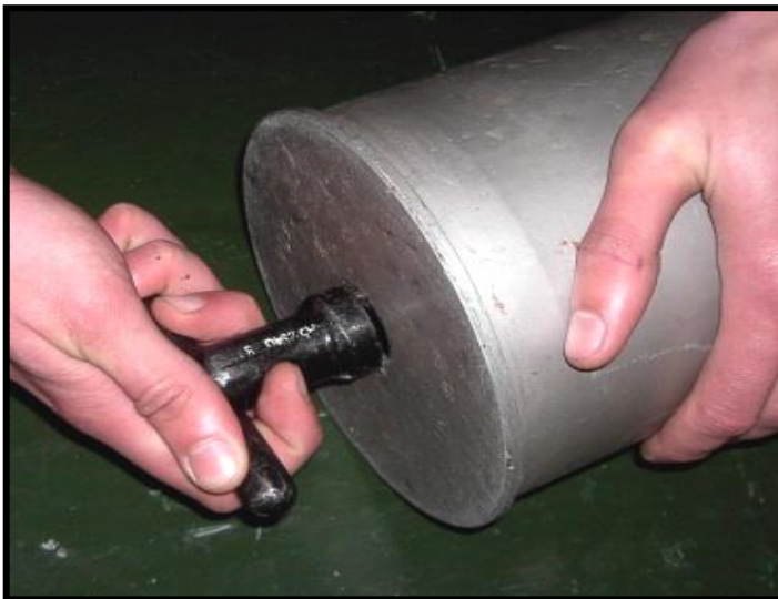
Рисунок 6.32 – Догвинчування капсульної втулки
