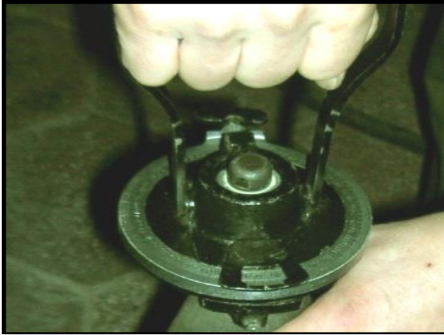
Рисунок 6.8 – Установка ключа ЗИ36 на підричник
