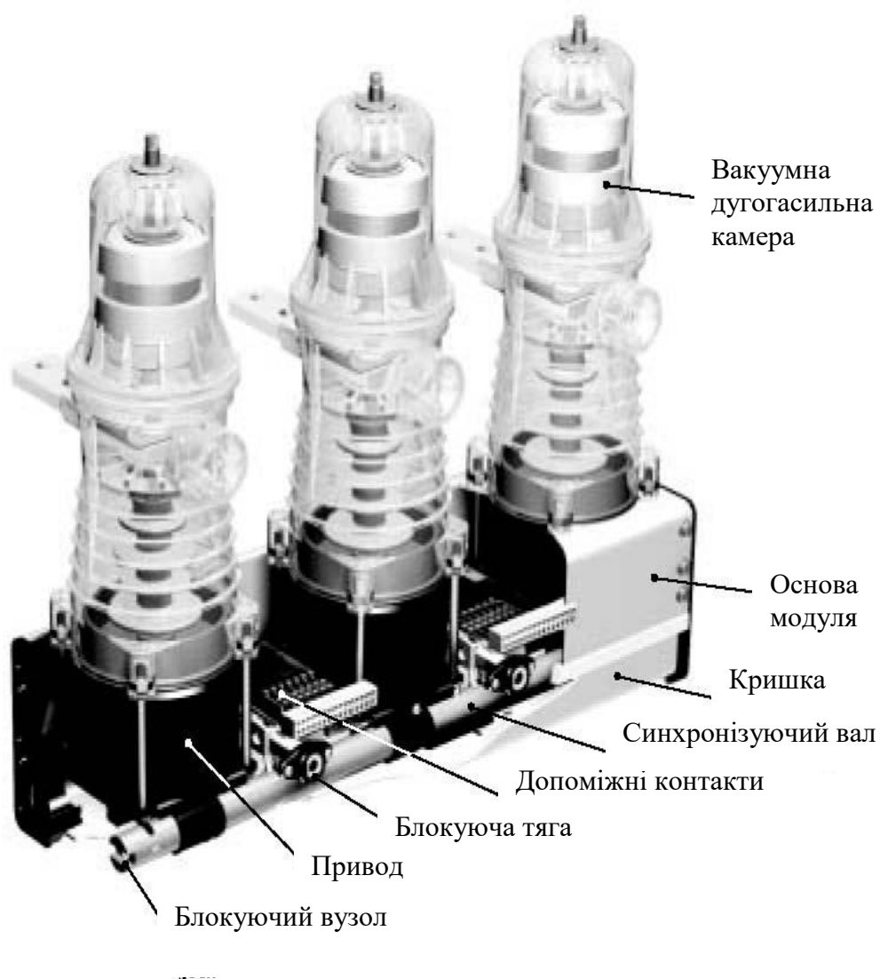
Рис. 1.4. Вакуумний вимикач типу ВВ/TEL
