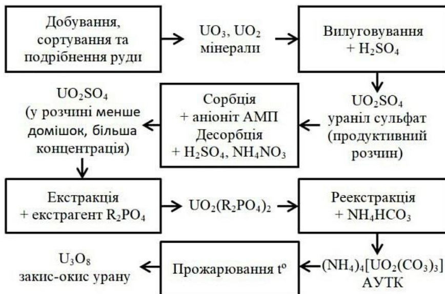
Рисунок 1 - Схема стадій виробництва закису-окису урану.
