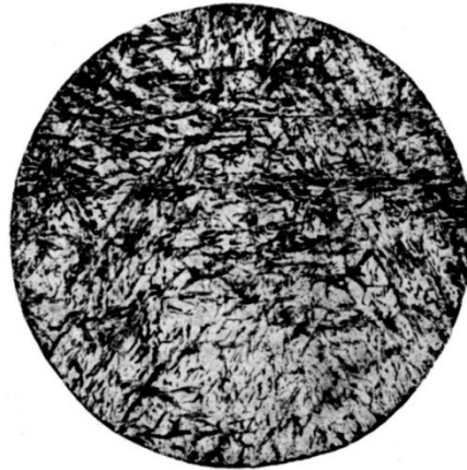
Рисунок 4.2 – структура загартованої сталі 40ХФА – мартенсит.
