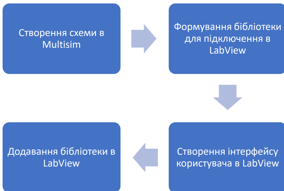
Рисунок 2.2 – Алгоритм імплементації функцій Multisim в LabView
