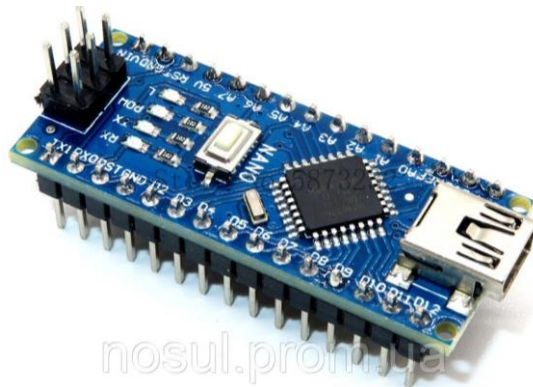
Рисунок 1.5 – Зовнішній вигляд мікроконтролерної платформи Arduino Nano
