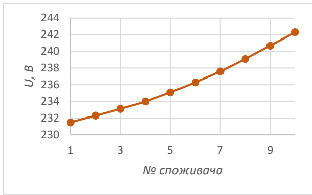
Рисунок 2.16– Графіки зміни напруг за наявності СЕС в останнього споживача:
