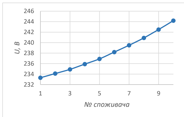
Рисунок 2.17 – Графіки зміни напруг за наявності СЕС у першого та останнього споживачів: а) при денному навантаженні, б) при вечірньому навантаженні
