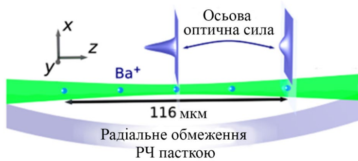
Рисунок 1.3 – Схема захоплення іонів Ba^+ оптичною пасткою у радіальній площині і РЧ пасткою у осьових площинах. Адаптовано з праці [15]
