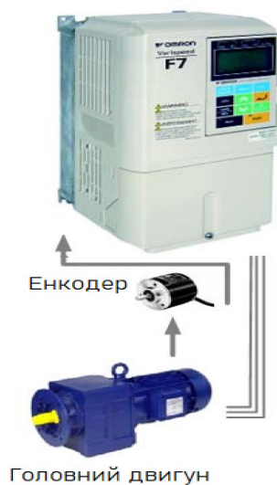
Рисунок 3.8 – Схема підключення CIMR-F721P5
