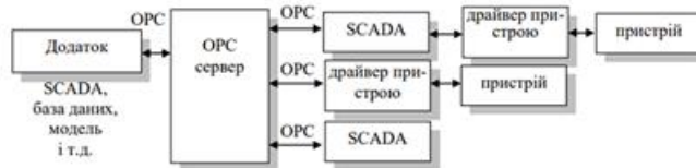
Рис. 1.4. Варіанти обміну SCADA-систем
