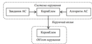
Рис. 1.1. Структура системи керування: КерівЕлем – керівний елемент; КеровЕлем – керований елемент
