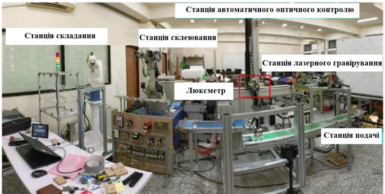
Рис. 2.2. Виробнича лінія з окремими станціями
