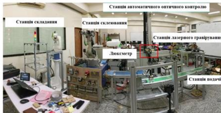
Рис. 2.2. Виробнича лінія з окремими станціями
