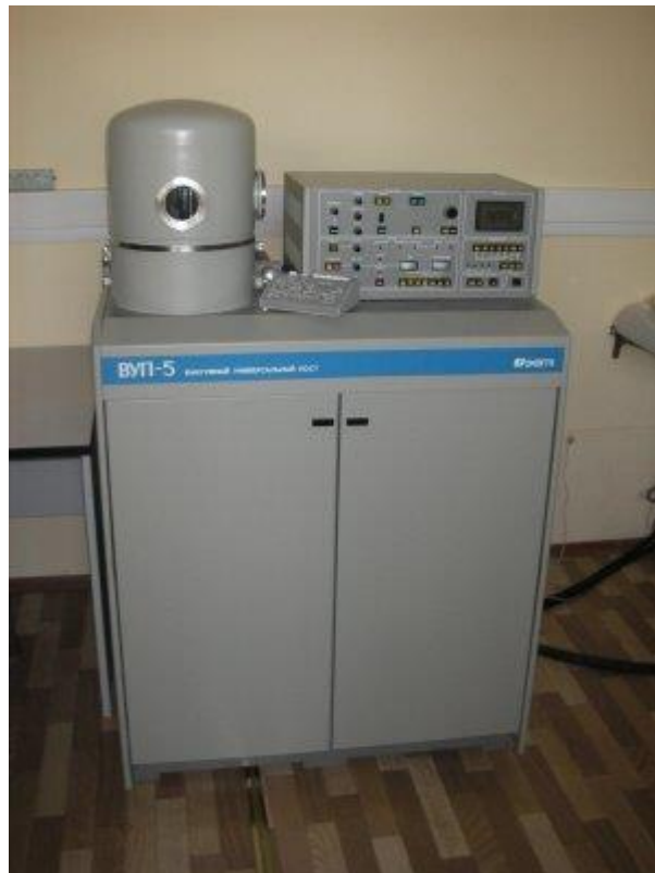
Рис. 2.1. Вакуумний Універсальний Пост (ВУП – 5М).
