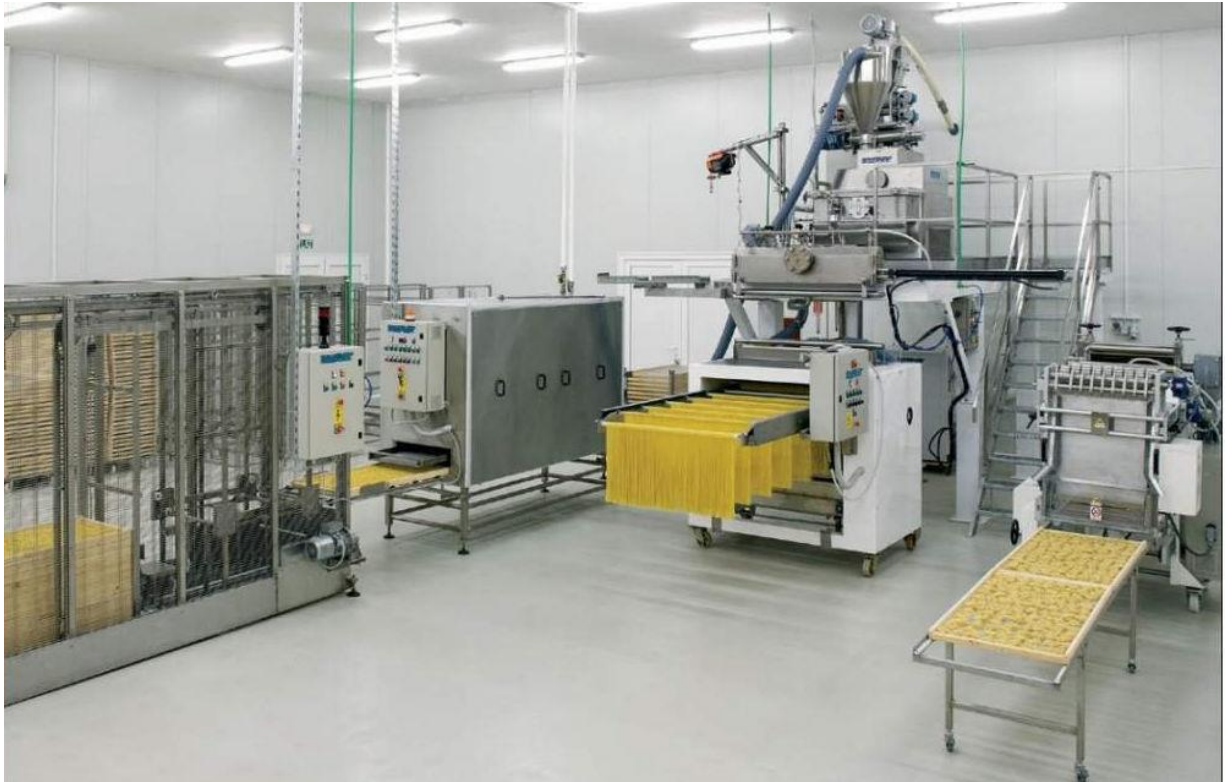
Рисунок 1.1 - Автоматизована лінія з виробництва макаронних виробів
