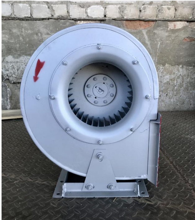
Рисунок 3.12 - Відцентрований вентилятор ВЦ 14-46 №2,5 5,5 кВт
