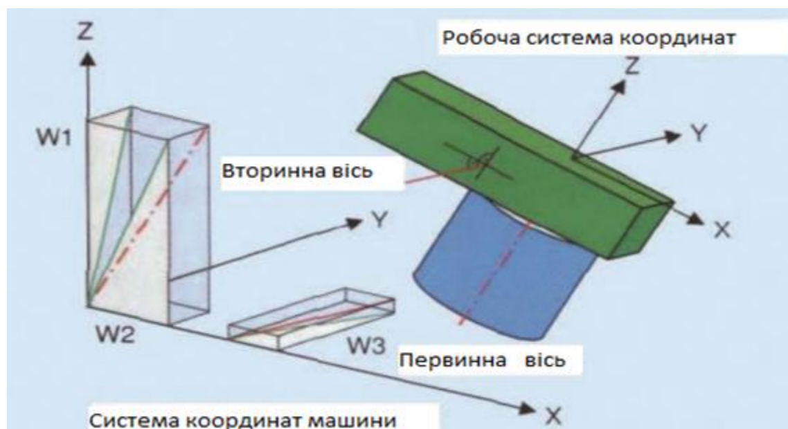
Рисунок 1.2 – Система координат сканованого об'єкта та КВМ
