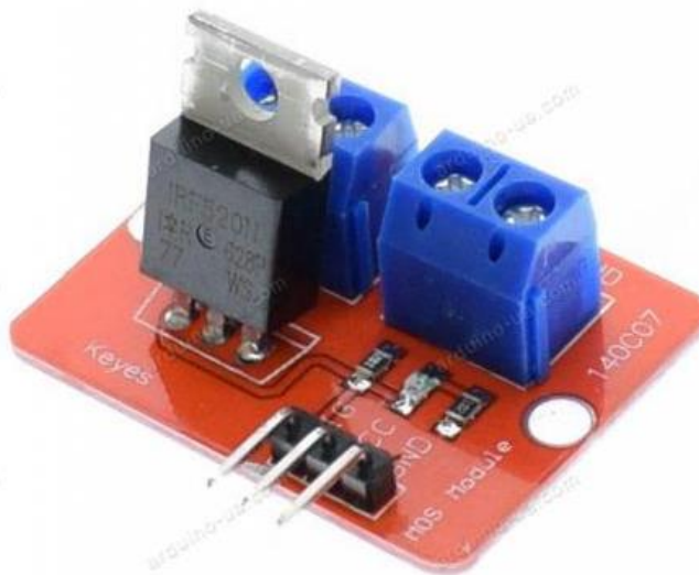
Рисунок 3.4 – Драйвер на транзисторі MOSFET IRF520[15]
