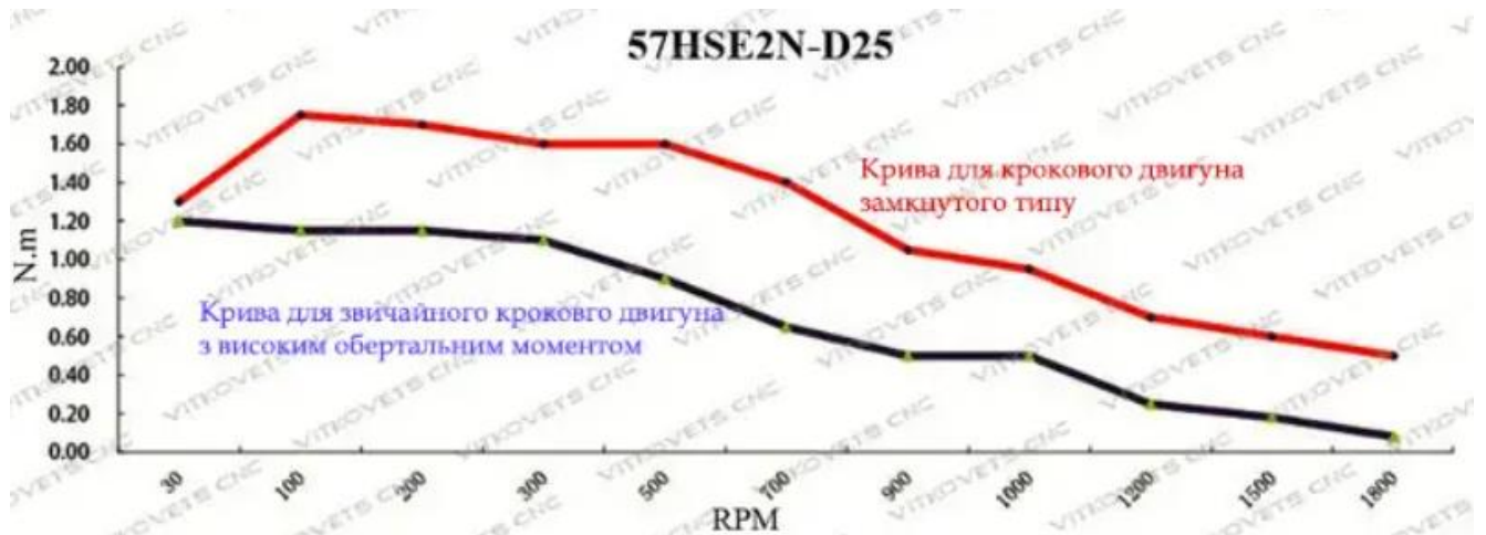
Рисунок 3.13 - Графік залежності обертового моменту від швидкості обертання[20]
