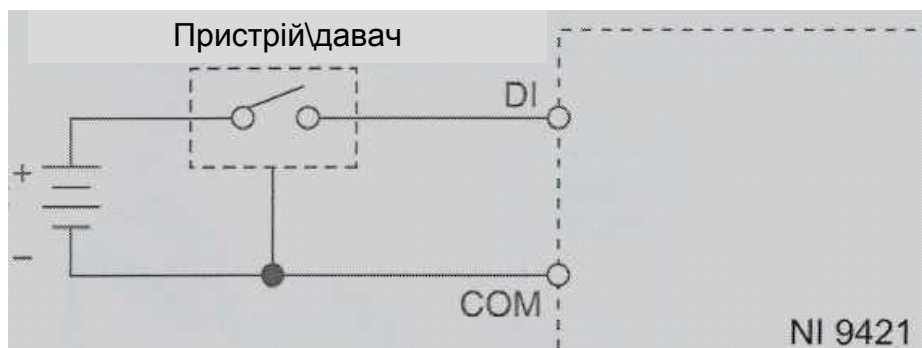
Рисунок 3.7 - Схема підключення пристрою/датчика до модуля «NI 9421»
