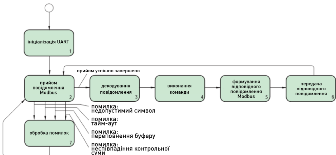
Рисунок 3.5 - Узагальнений алгоритм роботи веденого пристрою Modbus
