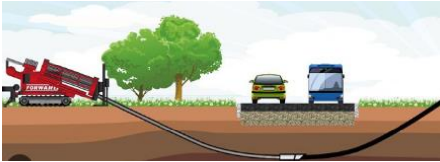
Рисунок 3.3 – Робота установок методом ГНБ
