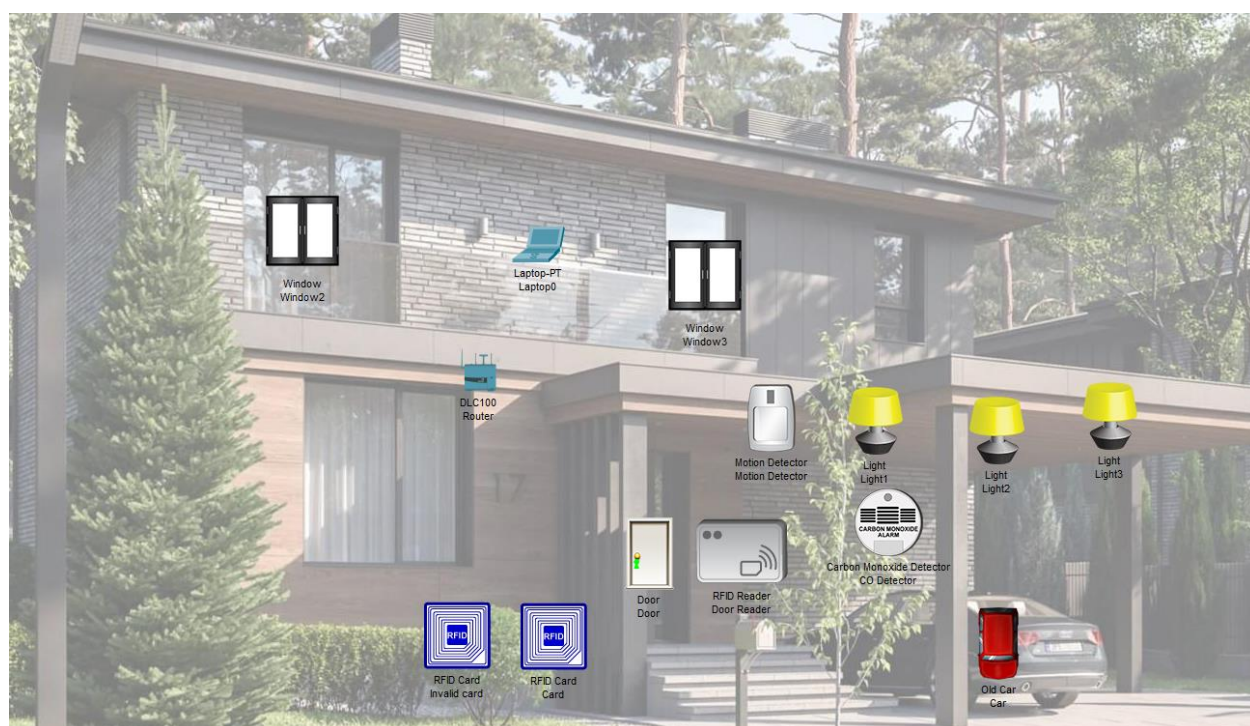
Рисунок 2.4 - Розташування пристроїв розумного будинку
