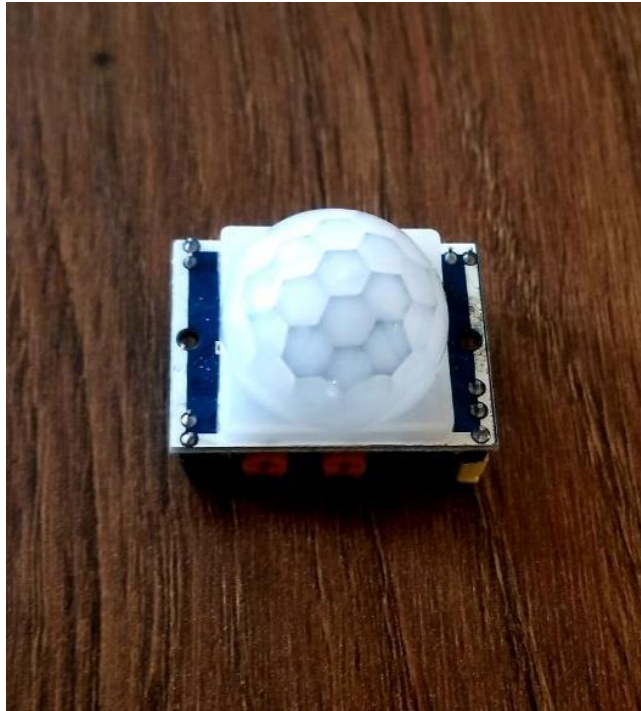
Рисунок 3.2 – Інфрачервоний датчик HC-SR501
