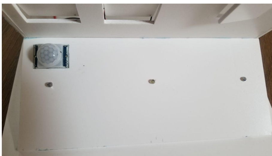
Рисунок 3.11 – Розташування світлодіодів та датчику руху
