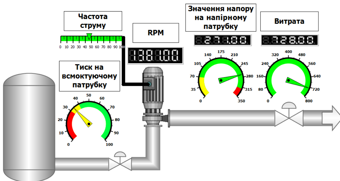
Рис. 6.2 SCADA система при незначному падіння тиску
