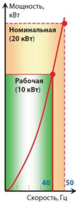
Рис. 5. 13 Залежність корисної потужності від частоти обертання
