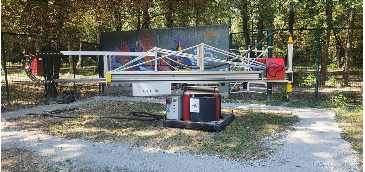
Рисунок 1.5 - Будівельний 3D принтер від компанії Mellivora
