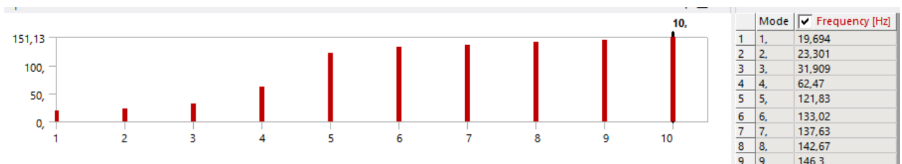
Рисунок 2.10 Результати власних форм коливань при модальному аналізі
