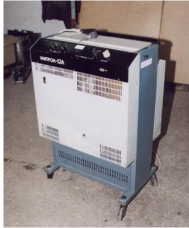
Рисунок 2.2 – Установка Елітрон-52А для проведення ЕІЛ
