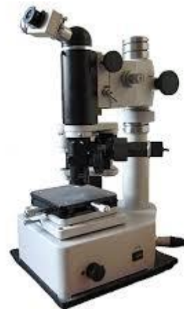
Рисунок 2.4 – Твердомір ПМТ-3: а – схема: 1 – зразок (шліф); 2 – предметний столик; 3 – об’єктив; 4 – вага; 5 – рукоятка предметного столика; 6 – алмазна піраміда; 7 – рукоятка аретира; б – фото
