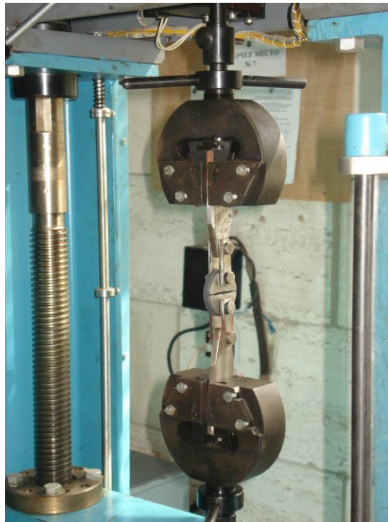
Рисунок 2.1 - Пристрій для випробувань зразків на розтягування.
