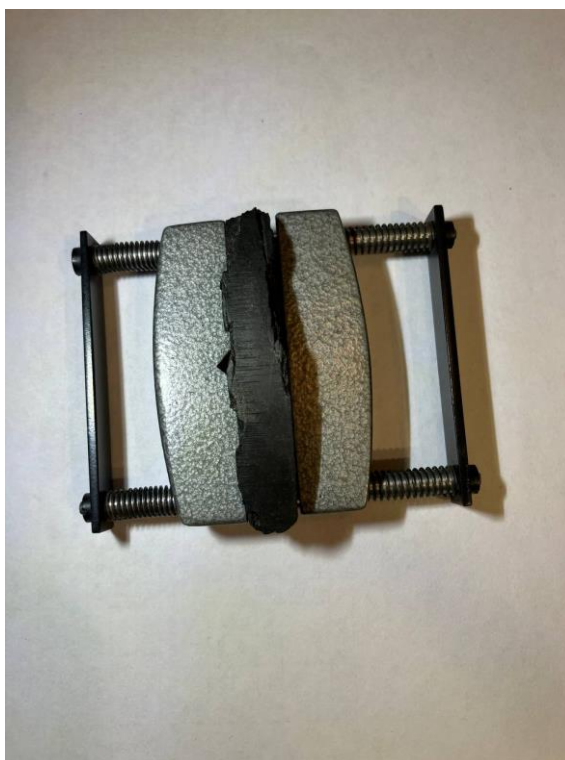
Рисунок 3.3 - Зруйноване кільце поршня (вид С).
