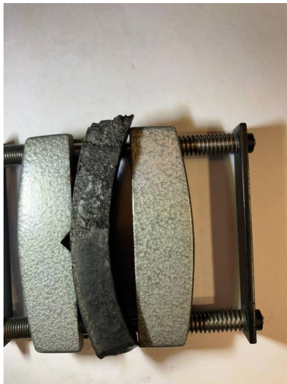
Рисунок 3.1 - Зруйноване кільце поршня (вид А).
