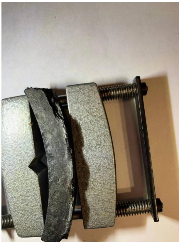
Рисунок 3.2 - Зруйноване кільце поршня (вид В).
