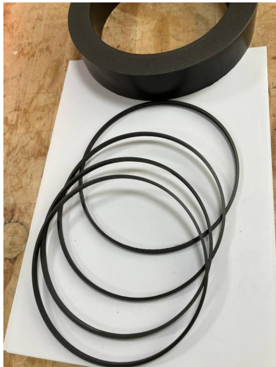
Рисунок 3.4 - Виготовлені зразки по формі кілець з розмірами \varnothing 146 \times \varnothing 142 \times 5 мм з досліджуваного матеріалу.
