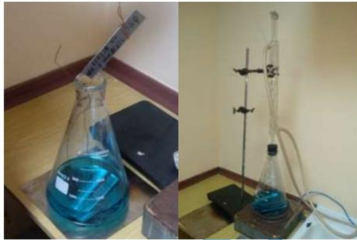
Рисунок 2.10 – Випробування зразків сталі 12X18H10T та наплавленого металу на стійкість проти міжкристалічної корозії за методом АМУ
