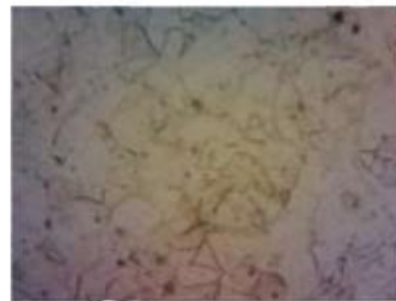
Рисунок 3.4 - Мікроструктура сталі 12X18Н10 після випробування на стійкість проти міжкристалічної корозії за методом АМУ
