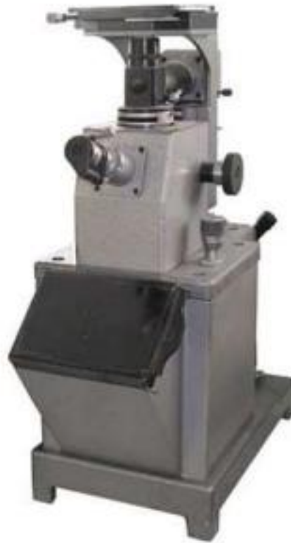
Рисунок 2.6 – Загальний вигляду мікроскопу МИМ-7 [41]
