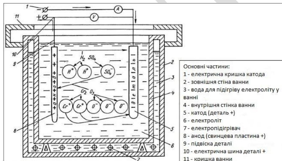
Рисунок 1.4 – Схема хромування деталей [15]
