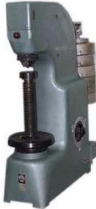
Рисунок 2.8 – Стационарний твердомір ТШ-2М [43]
