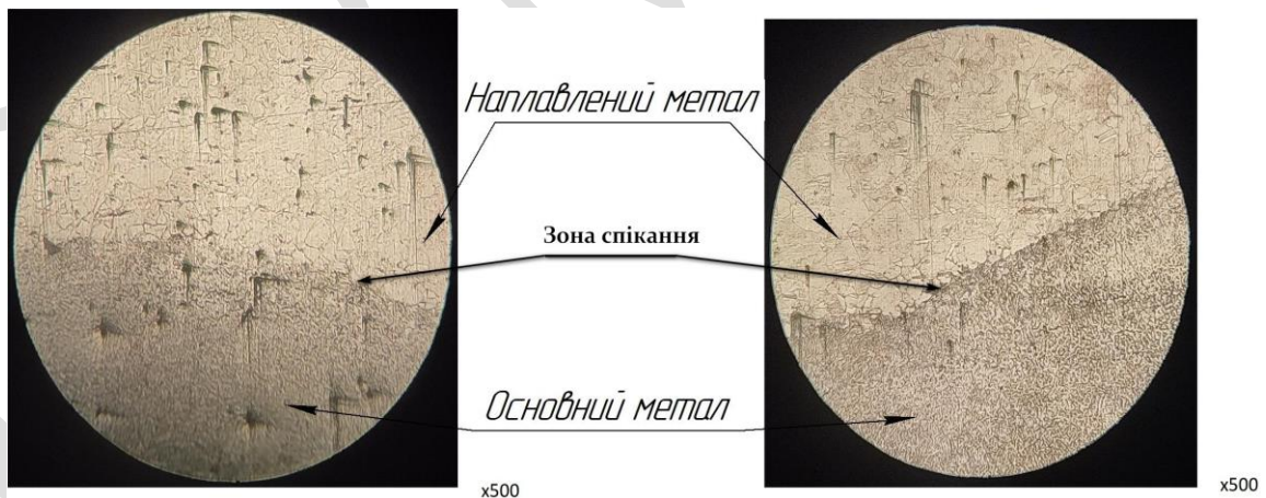
Рисунок 3.2 - Структура основного металу та лінія переходу наплавленого металу
