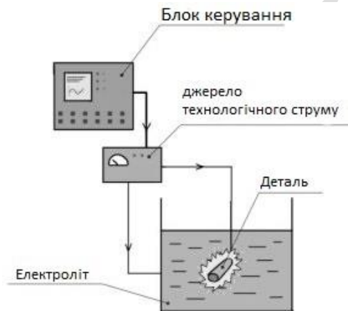
Рисунок 1.2 – Загальна схема установки для мікродугового окиснення [10]
