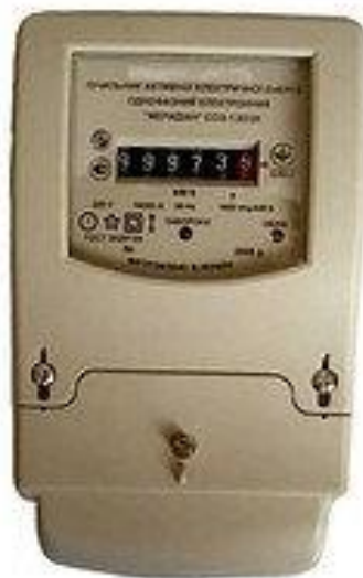
Рисунок 1.4 – Лічильник електричної енергії [5]
