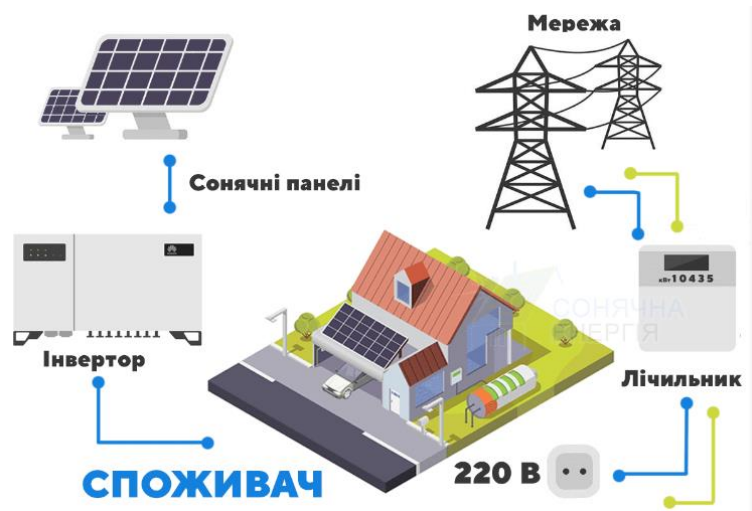
Рисунок 2.2 – Принципова схема встановлення сонячної електростанції [21]
