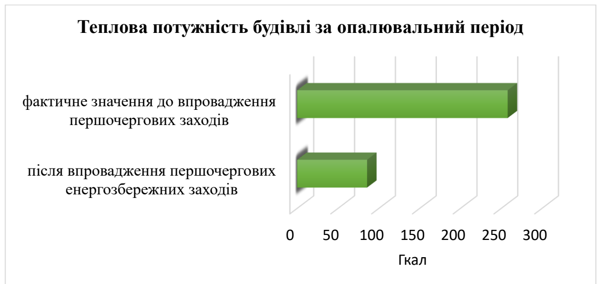
Рисунок 2.3 – Порівняння значення теплової потужності будівлі за опалювальний період до та після впровадження першочергових енергозберіжних заходів
