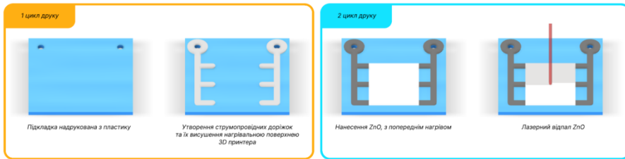
Рисунок 1 - Процес 3D друку фотосенсора на основі ZnO
