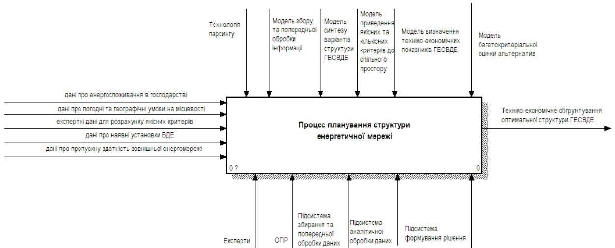
Рисунок 4.1 – Контекстна діаграма процесу інформаційної підтримки планування енергетичної інфраструктури з відновлюваними джерелами енергії
