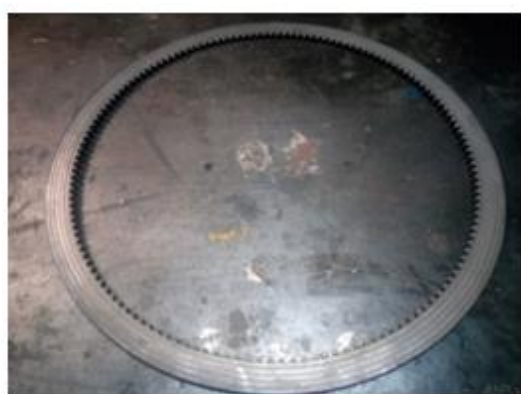
Рисунок 2.6 - Біметалевий зубчатий диск внутрішнього зачеплення з фрикційним покриттям а) та його конструктивні параметри б).
