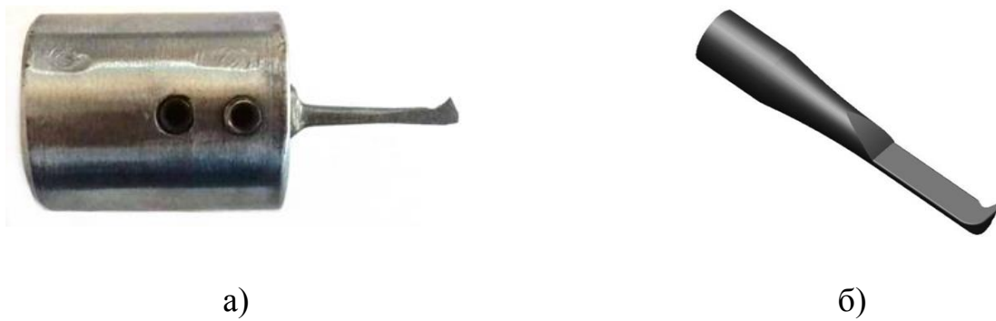
Рисунок 1.4 – Однозубий інструмент для оброблення круглої різьби: а) фото однозубого інструмента, що кріпиться в спеціальній втулці; б) 3D-модель інструмента, виконана в середовищі SOLIDWORKS
