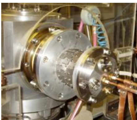
Рисунок 2 – Внешний вид ВЧМКИИ (а) и ВЧ антенны (б)
