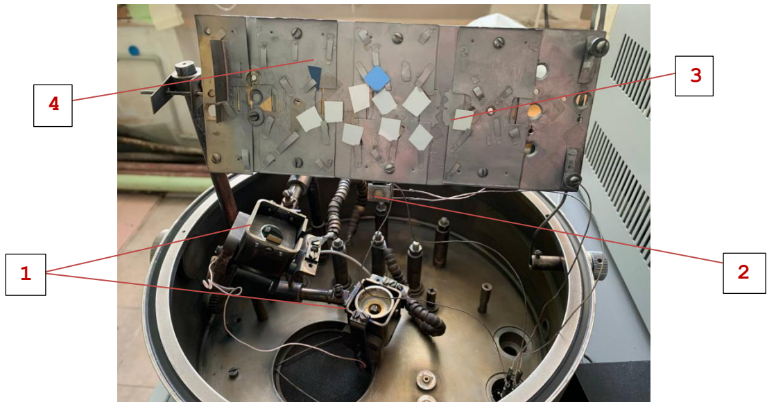
Рисунок 2.1 - Робоча камера установки ВУП-5М: 1 – електронно-променеві гармати, 2 – кварцеві резонатори, 3 – ситалова підкладка, 4 – мікроскопічна сіточка
