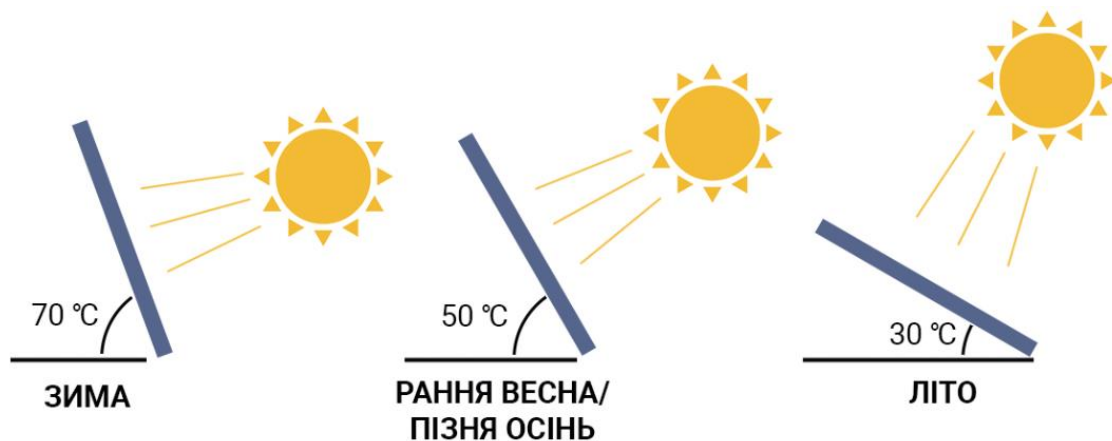
Рис. 1.3. Оптимальний кут нахилу ФЕП відносно сонця [9]
