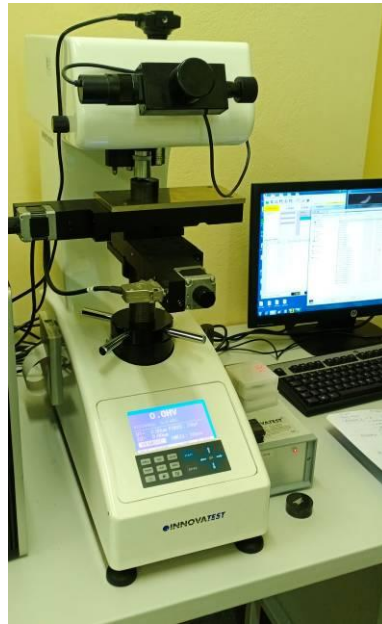
Рисунок 3.3 – Фото твердоміру NOVA 330/360
