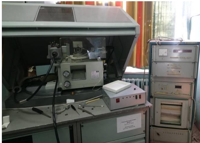
Рисунок 2.4 – Фото дифрактометра ДРОН-3
