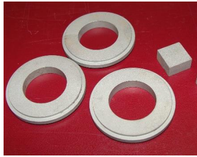
Рисунок 4.3 – Зразки для випробування на трибо тестері і металографічні дослідження (прямокутні)
