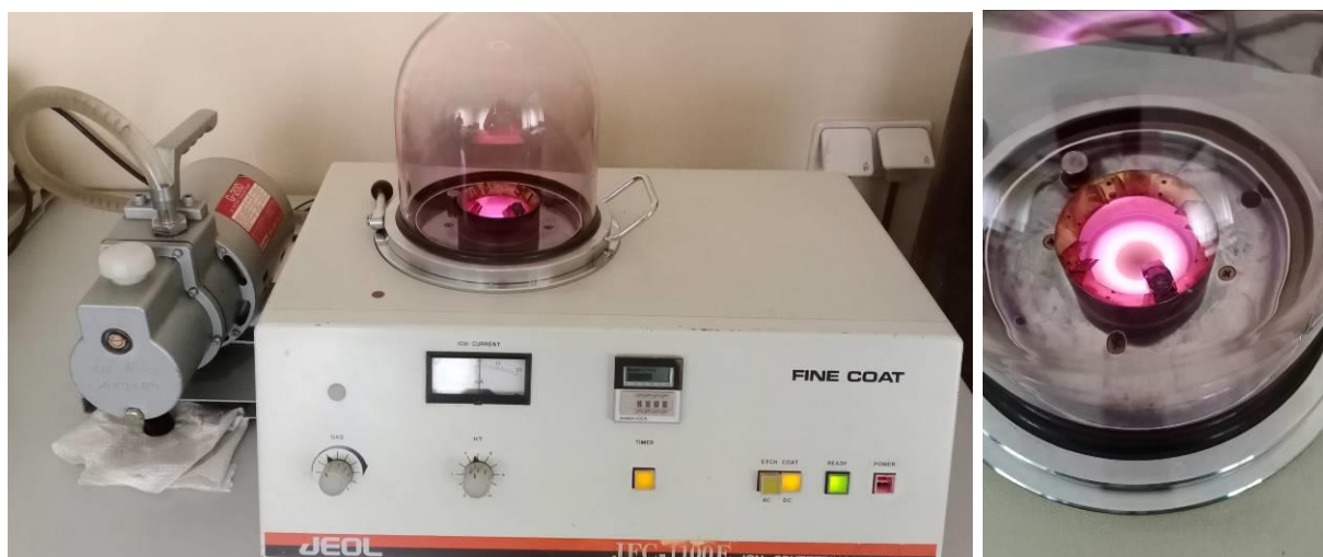
Рисунок 3.5 – Фото іонно-напилювального пристрою JFC-1100E
