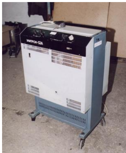
Рисунок 2.1 – Установка «Елітрон-52А» для проведення ЕІЛ
