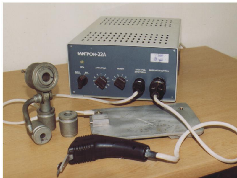
Рисунок 3.1 – Установка «Елітрон-22А» для проведення ЕІЛ
