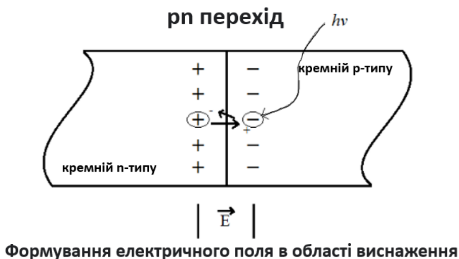
Рисунок 1.4 – Ілюстрація pn переходу . Адаптований з роботи [5].
