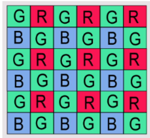
Рисунок 2.1 – Розміщення світлофільтрів в Баєрівській схемі. Адаптовано з роботи [14]
