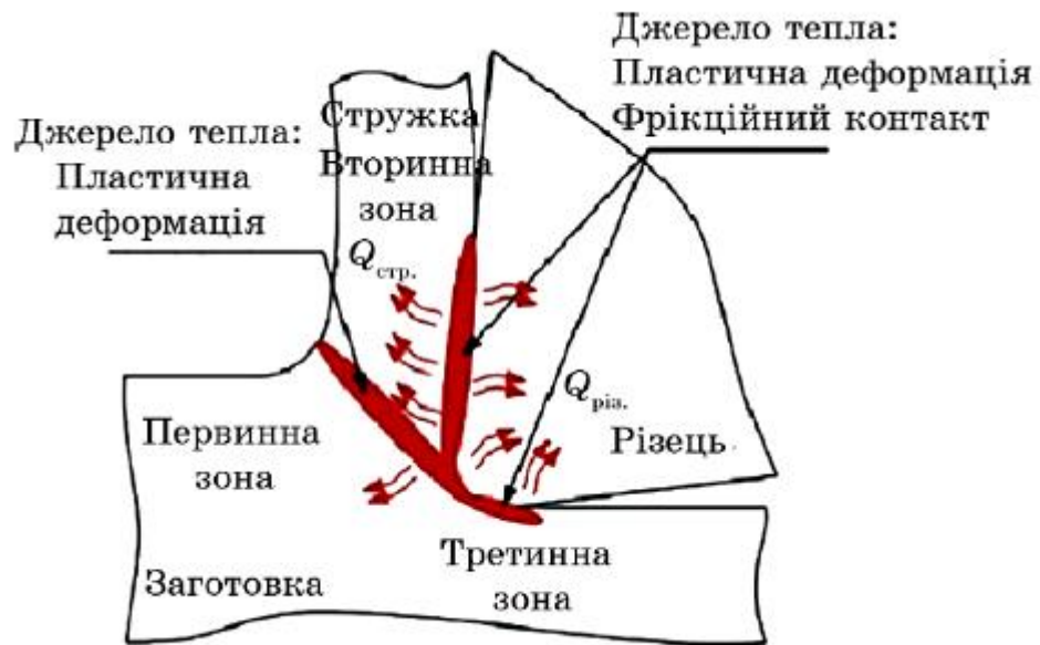
Рисунок 3 – Основні джерела тепла під час формування стружки при механічному обробленні [78]
