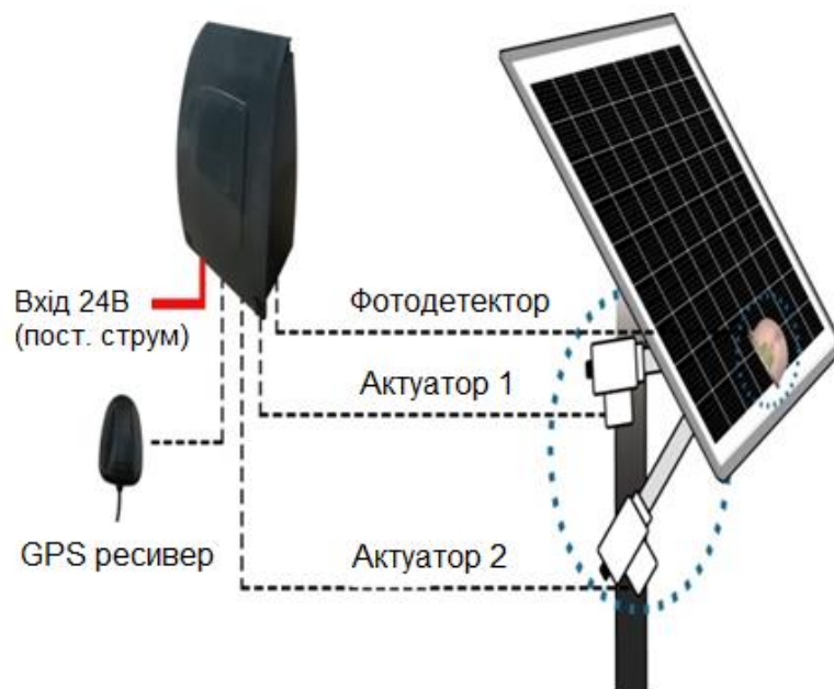
Рисунок 2.9 – Схема управління на основі фотоприймачів
