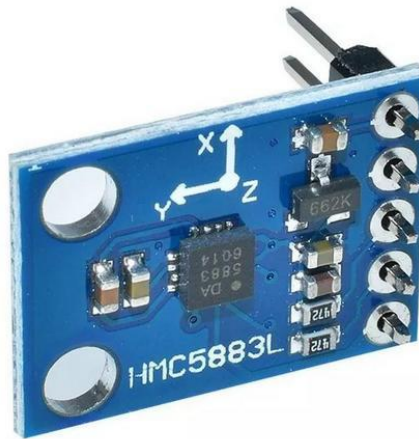
Рисунок 4.4 - Трьохосьовий магнетометр компас HMC5883L
