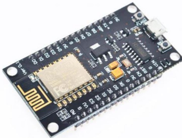
Рисунок 4.11 - Контролер ESP8266 NODEMCU V3
