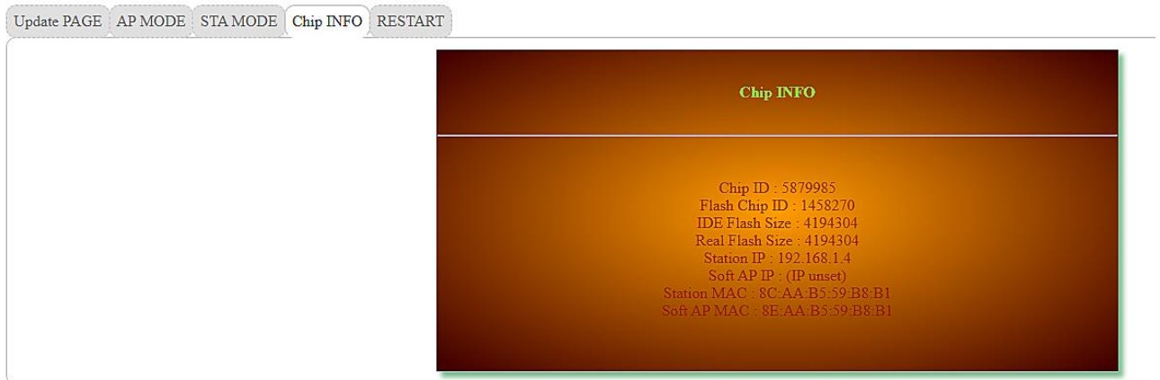
Рисунок 5.9 - Вкладка з індивідуальними мережевими параметрами пристрою
