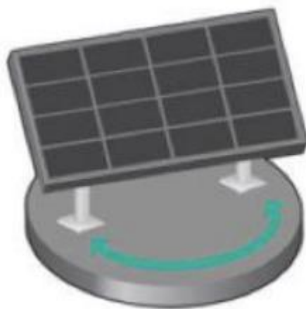
Рисунок 2.3 – Вертикальний одноосьовий трекер
