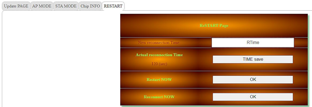
Рисунок 5.10 - Вкладка для налаштування автоматичного підключення пристрою або дистанційного перезавантаження підсистеми SICT
