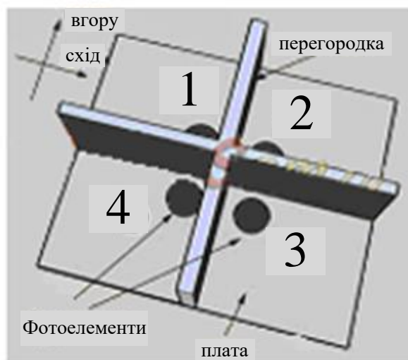
Рисунок 4.1 – Конструкція давача освітленості
