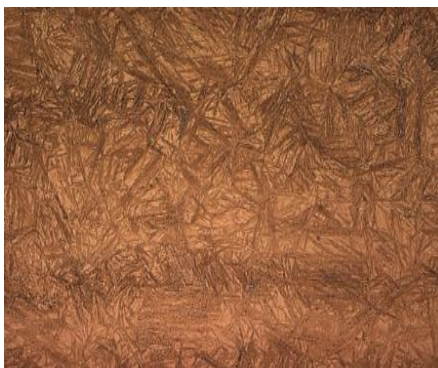
Рисунок 2.1 – Мікроструктура зміцненого шару зразка зі сталі 40X13 X500 [14]
