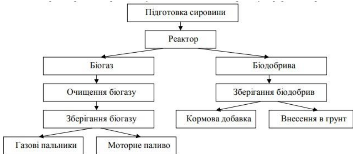
Рисунок 2.3 – Схема переробки органічних відходів на біогазових установках
