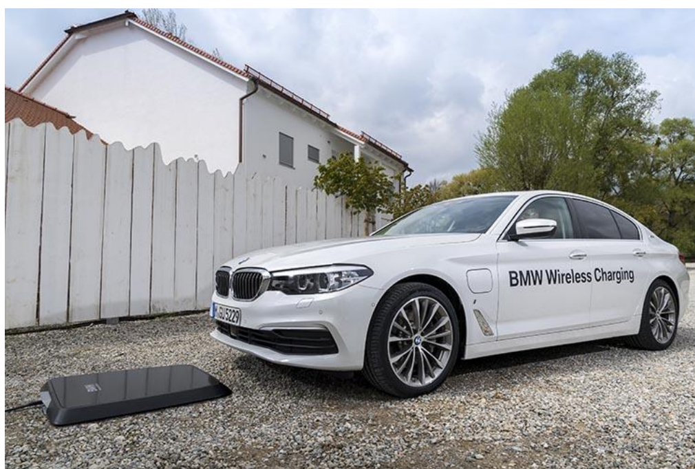
Рисунок 4.2 - Бездротова індукційна зарядка електромобілів [15]
