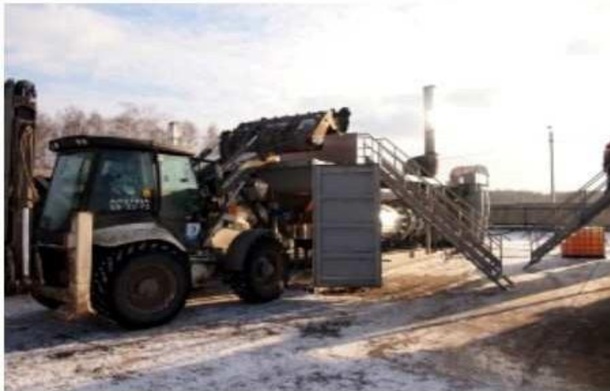
Малюнок 2.5 – Завантаження ковшовим навантажувачем
