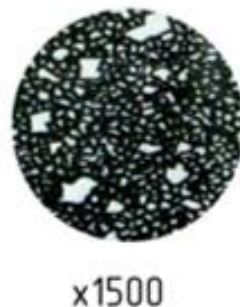
Рисунок 5.1. Структура сталі Р6М5К5 після кування та відпалу
