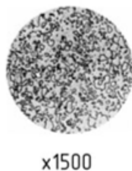
Рисунок 5.2. Сталь Р6М5К5 після гартування
