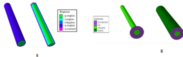
Рис. 2.1. Геометрії радіального нанодіодового сонячного елемента на основі GaAs/AlGaAs p-i-n-гетеропереходу та відповідний зріз з відображенням робочих областей (а) та відповідних матеріалів (б)
