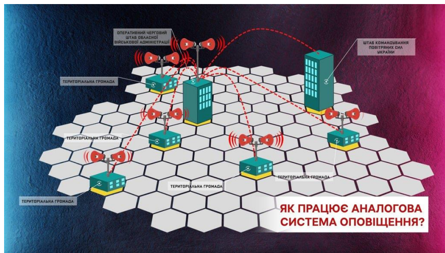
Рисунок 2.4 – Робота Аналогової системи оповіщення у вигляді одного ланцюга.
