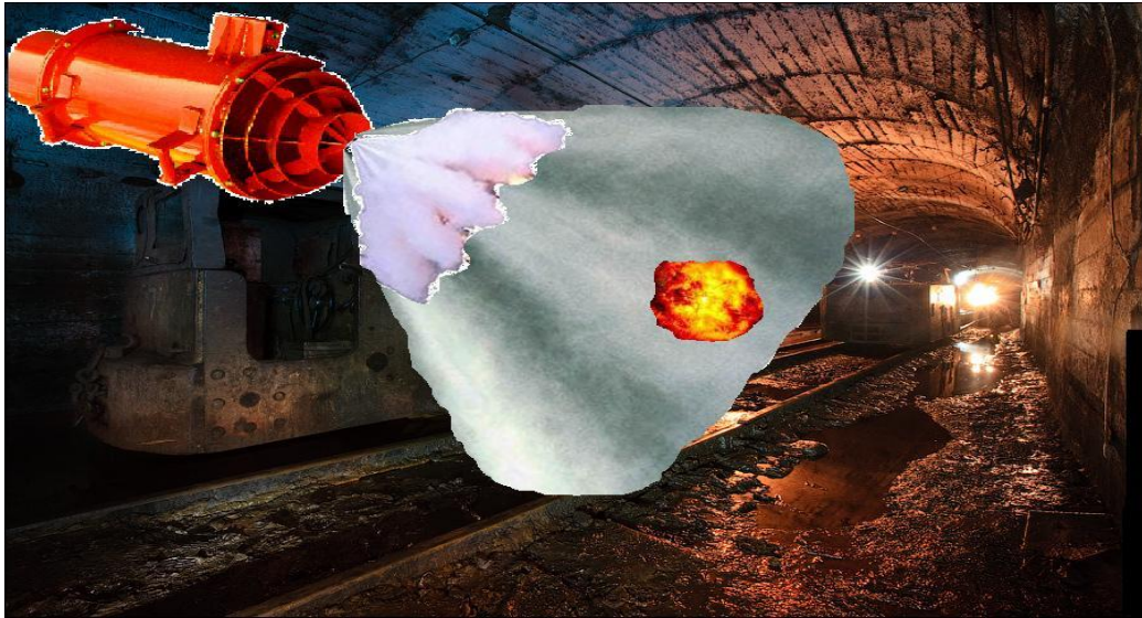
Рис.3.2.5. Фрагмент роботи системи при автоматичному вибухопожежогасінні в шахті при спалаху метану
